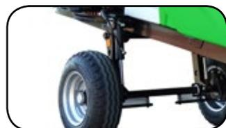
12 Conjunto elevación hidráulica del eje
