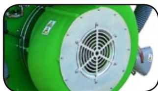
2 Turbina centrífuga para nebulizador de 8 salidas.
