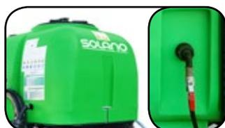
3 7 Depósito principal de polietileno con agitador.
